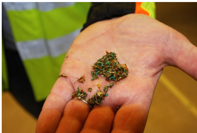
Figur 10. Plastpartikler i fiberrest etter siling med lysåpning 2 mm [44]
